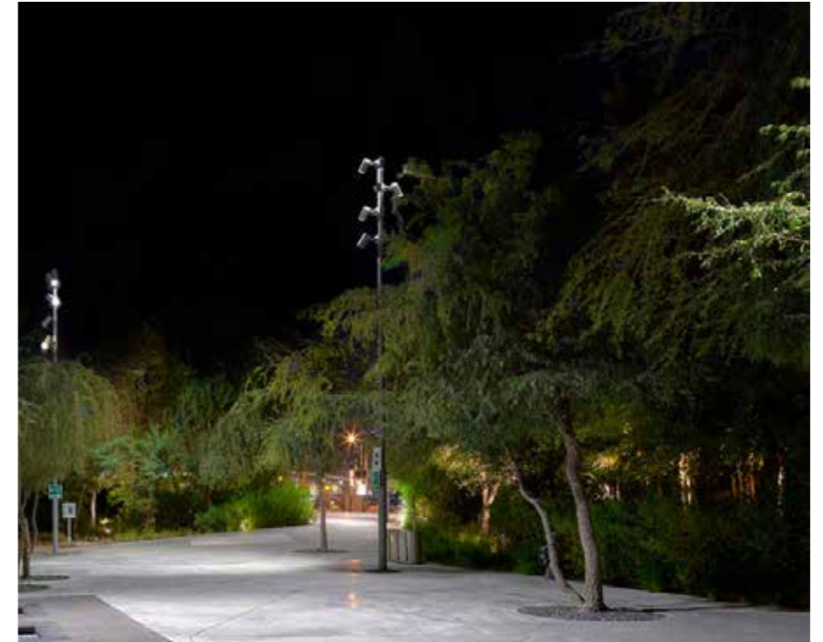
Spotlights på mast/stolpe förstärker ljuset vid platser för aktivitet. (bildkälla: iGuzzini, foto Philip Handforth)
