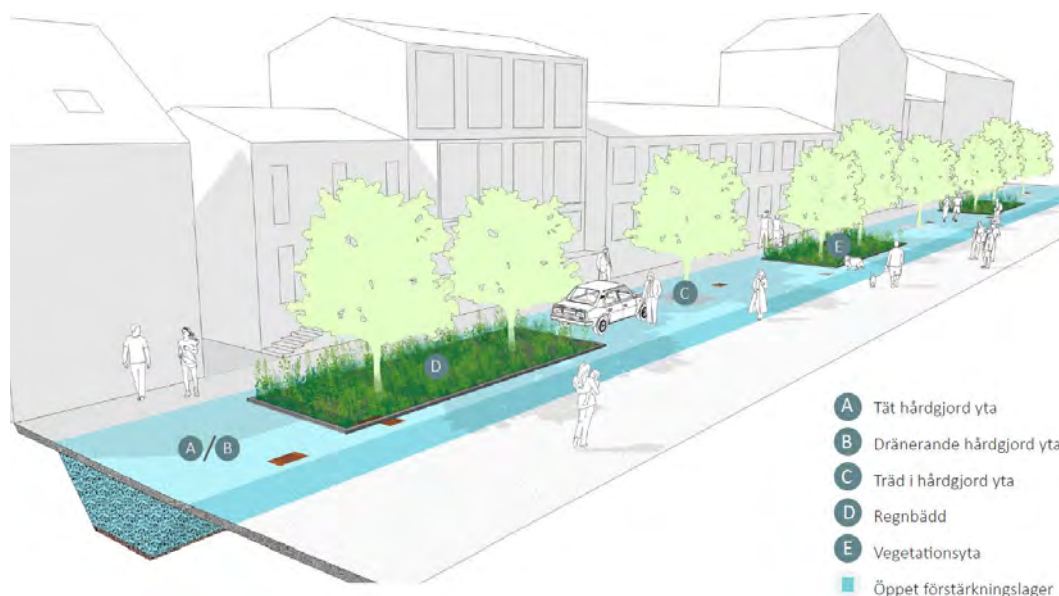
Figur 17. Exempel på princip för BGG-system i gatans möbleringszon. Bildkälla: Levande stadsrum – en handbok i Blågröngrå system ver. 3.1 (Edge, 2022).
